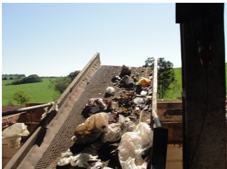
Figura 87: Esteira de triagem e cestos separadores.
