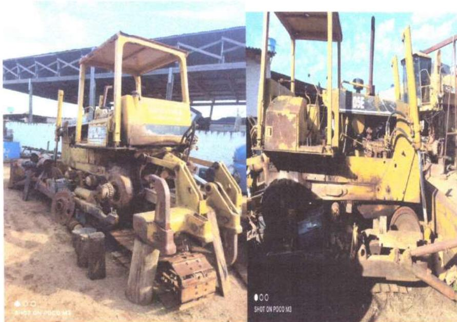
**Observação:** Trator de esteira caterpillar, parado a algum tempo por falta de peças, parou funcionando motor e parte hidráulica, porem necessita de reparos nas esteiras, freios e partes rodantes para voltar a funcionar.
