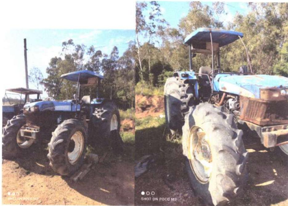
**Observação:** Trator ford 7630, pneus em boas condições, parte de estética, funilaria em péssimas condições, trator parou de trabalhar por problemas no motor, o mesmo não está funcionando. Outras partes mecânicas do trator estavam funcionando normalmente até o momento que parou. Necessita revisão geral.
