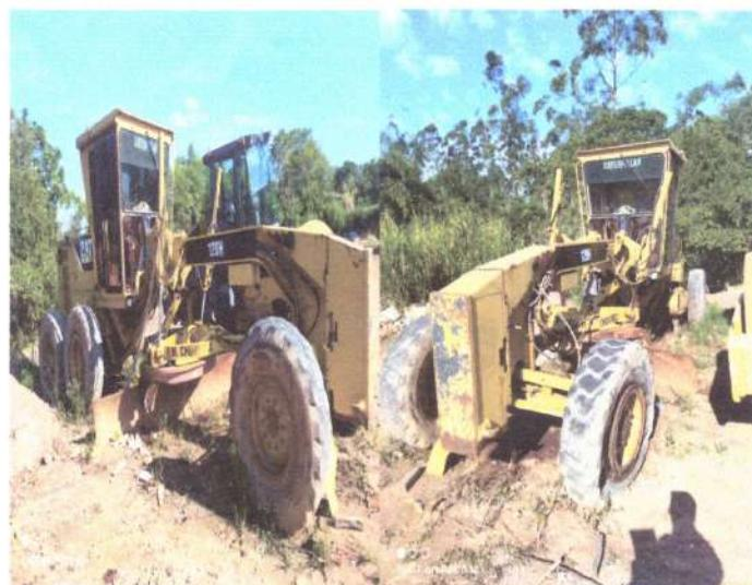
**Observação:** Máquina encontra-se parada, sem um pneu, com parte do material rodando aberto, pneus bastante gasto, possui vidros da cabine quebrados, parou por má funcionamento da parte de válvulas de transmissão. Além da transmissão a máquina necessita revisão geral para voltar a atividade.
