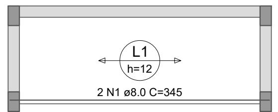
Armação positiva das lajes do pavimento Pavimento 1 (Eixo X)
