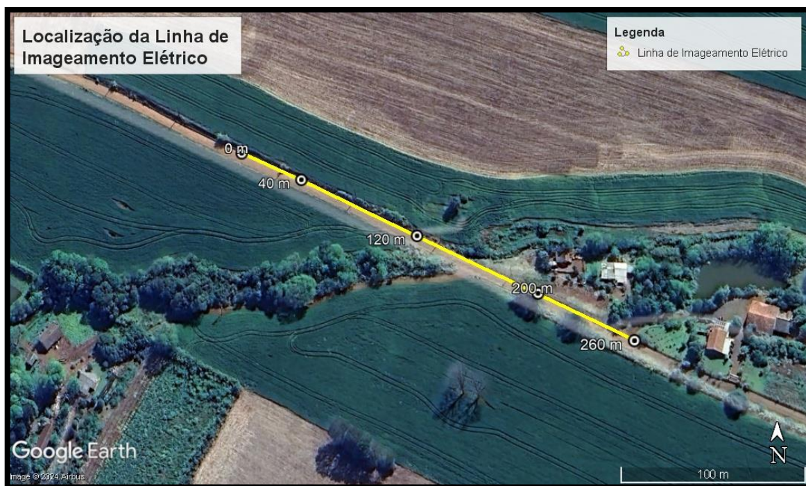
Figura 6. Localização dos eletrodos de injeção de corrente elétrica e medição de potencial.
