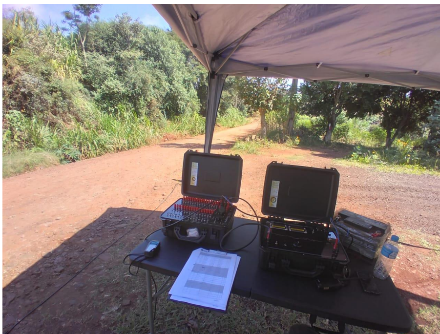
Foto 3. Eletrorresistivímetro utilizado para levantamento geofísico.
