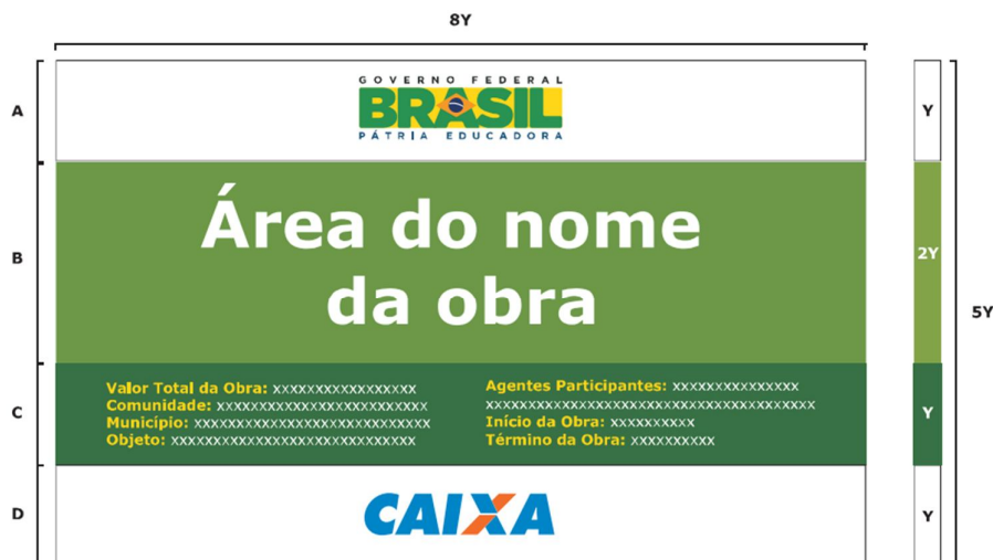
Figura 1 - Padrão de placa da obra
