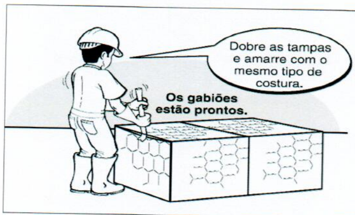
Figura 9: Detalhe da etapa de fechamento do gabião tipo caixa
