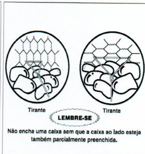
Figura 7: Detalhe da colocação dos tirantes
