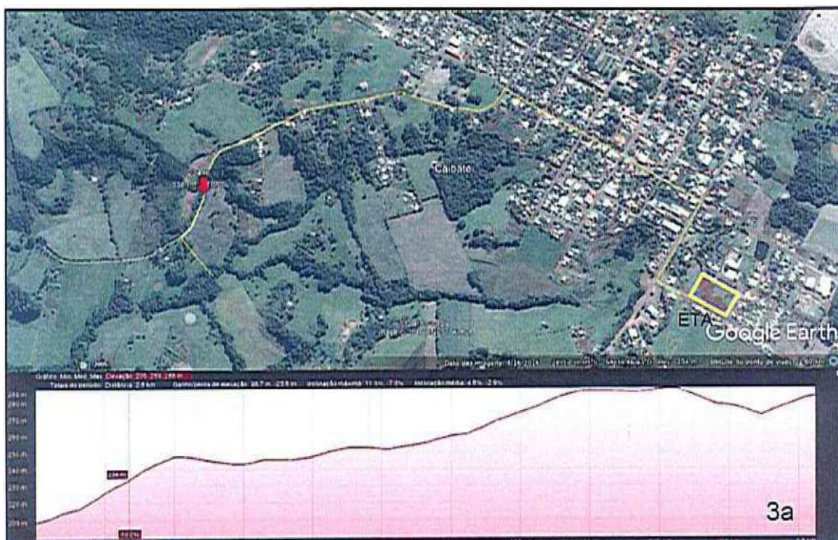
Figura 6. Traçado do caminho para passagem das adutoras da sub-bacia 3ª até a ETA proposta, e respectivo perfil de elevação.
