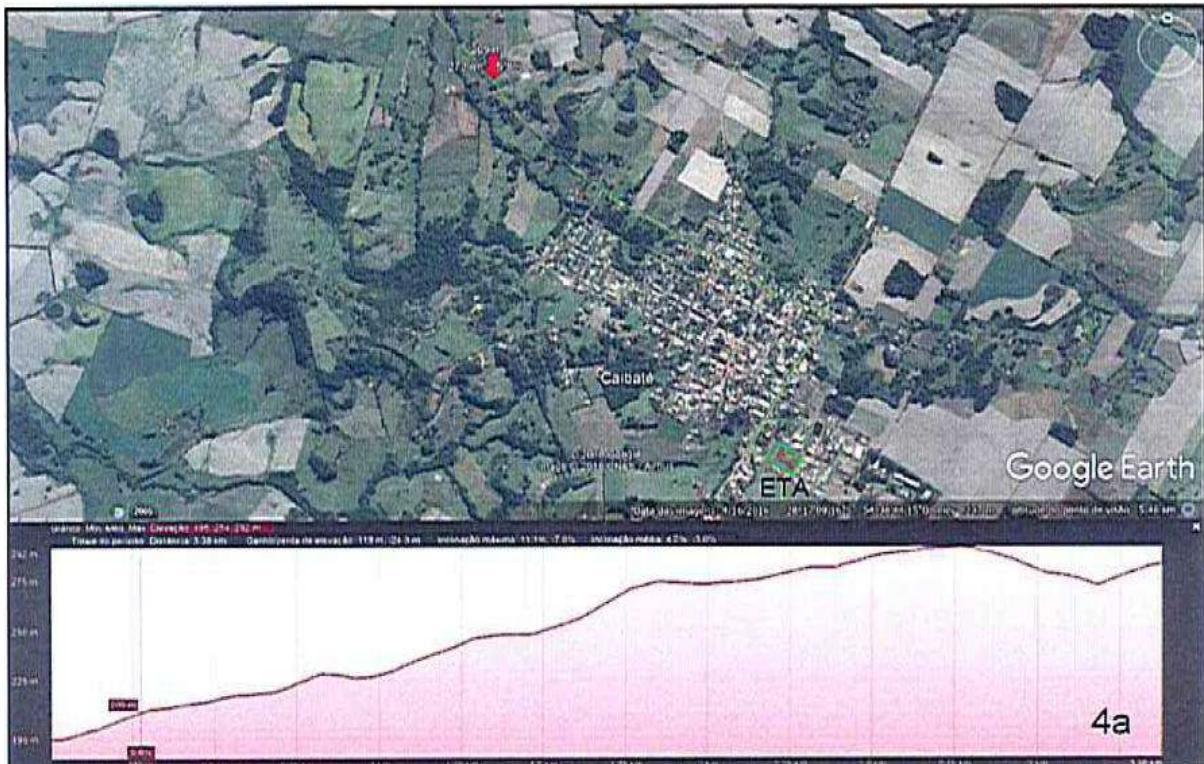
Figura 7. Traçado do caminho para passagem das adutoras da sub-bacia 4ª até a ETA proposta, e respectivo perfil de elevação.
