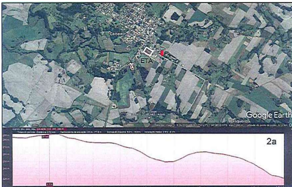
Figura 5. Traçado do caminho para passagem das adutoras da sub-bacia 2ª até a ETA proposta, e respectivo perfil de elevação.
