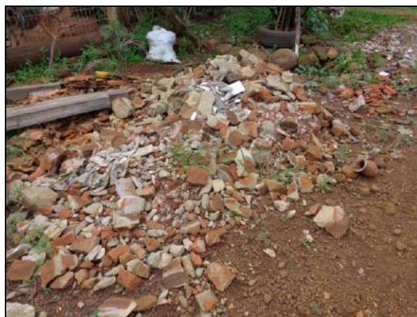
FOTO 05 – Disposição irregular RCC
