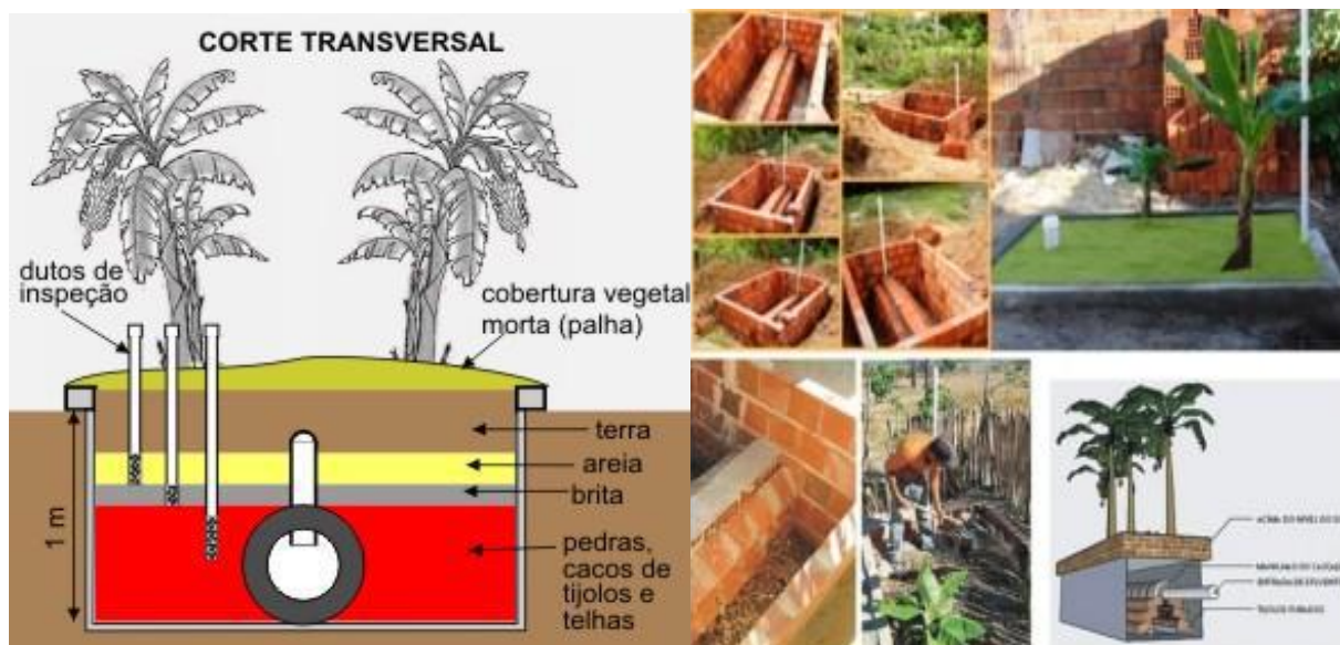
Figura 18. Sistema Ecológico para Tratamento do Esgoto Doméstico em Áreas Rurais, conforme Emater.
