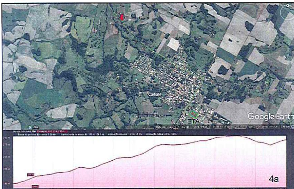
Figura 7. Traçado do caminho para passagem das adutoras da sub-bacia 4 a até a ETA proposta, e respectivo perfil de elevação.
